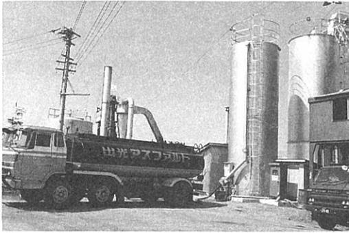
アスファルト運搬車とアスファルトタンク
