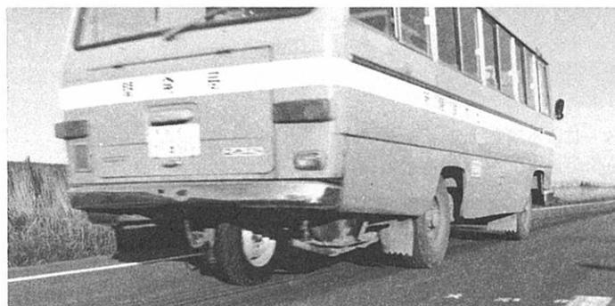
走行試験車による測定の状況 (提供：土木試験所)
